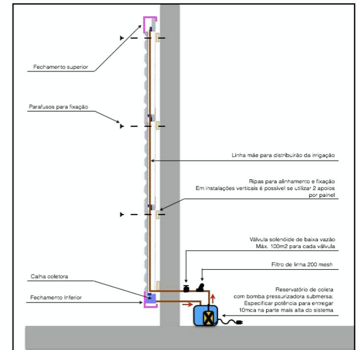
Fixação com parafuso autobrocante 5/16" x 4" com anel de vedação (5 parafusos/m2)
