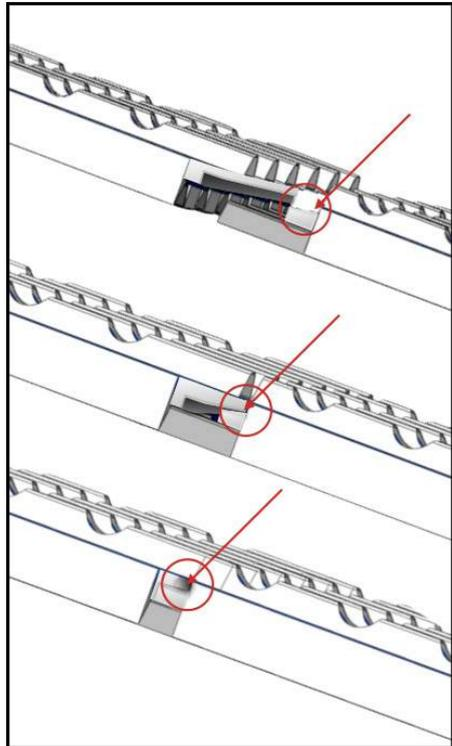
**Canal de irrigação** passagem transversal no encaixe entre cada telha, desenhado para acomodar uma linha de irrigação com até 20mm de espessura. Esse canal recebe a água servida da placa anterior
