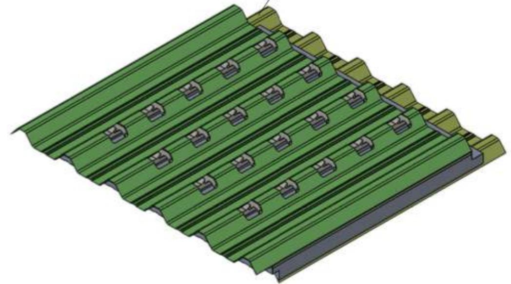
Área útil de recobrimento 0,9m<sup>2</sup>
