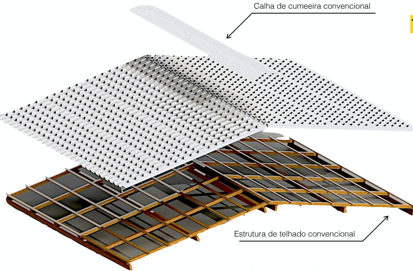
Inclinação mínima 10% (~6°) para telhados e painéis de cultivo
