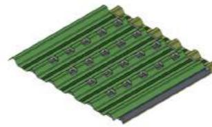
**Para telhados novos:** a **Kaatop sanduíche completo** foi feita para instalar como uma telha sanduíche convencional, com parafusamento direto sobre ripado de madeira ou estrutura metálica com 3 apoios por telha (espaçamento entre terças aprox. 30cm), sem a necessidade de impermeabilização adicional.
