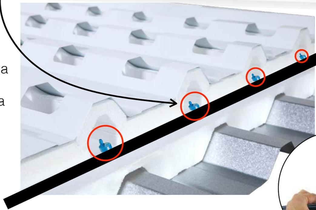
Instalação dos emissores nas mangueiras de irrigação: a água deve gotejar dentro do rebaixo na entrada de cada canal de cultivo.
